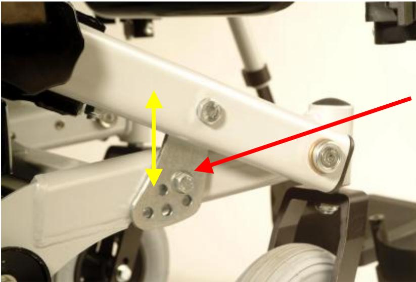
Ajuste de altura del asiento entre 45cm y 51 cm, en 5 posiciones, cambiando el tornillo en la pletina
