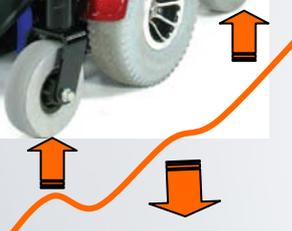
La tracción y dirección la lleva en sus ruedas centrales. Es una nueva dinámica de suspensión, permitiendo reducir los espacios necesarios para girar.
