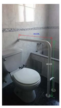
La Barra en L Muro-Piso fue diseñada como una ayuda de apoyo para el w.c. aunque su uso no se limita a esto solamente, puede ser usada como barras paralelas para ejercicio de bipedestación. Su pata de apoyo desmontable permite ser instalado el mismo producto, tanto como apoyo al lado izquierdo como al lado derecho. Fabricada en Acero y esmaltada en color blanco en un diámetro de tubo de 1"1/2.
