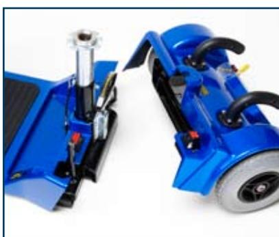
Tren trasero desmontable en segundos, con sistema de doble asa para facilitar su manejo
